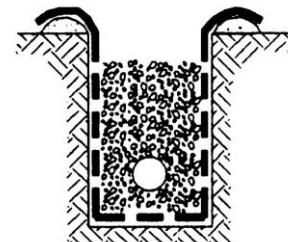
۴- ریختن مصالح زهکشی و تراکم
